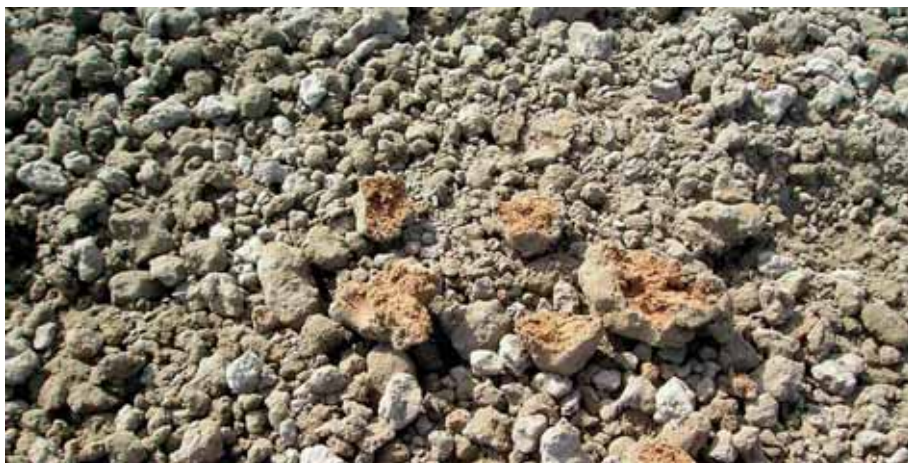
Рис. 1. Суглинок, измельченный и перемешанный с цементом ресайклером
