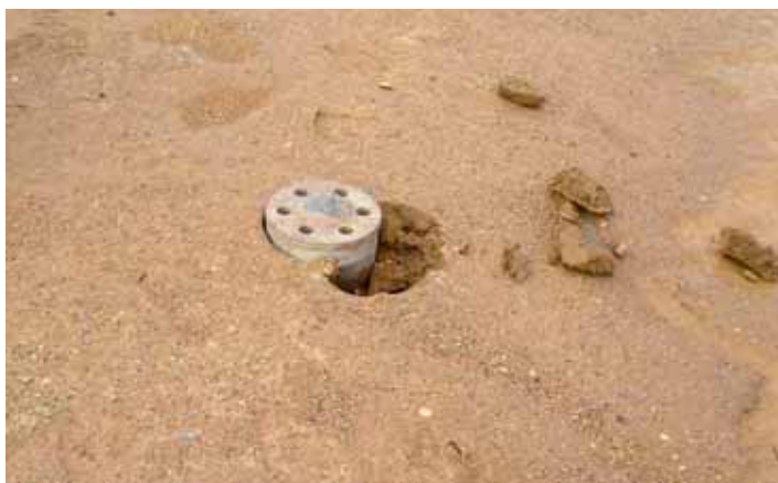
Рис. 6. Отбор проб с помощью режущего кольца из слоя стабилизированного грунта
