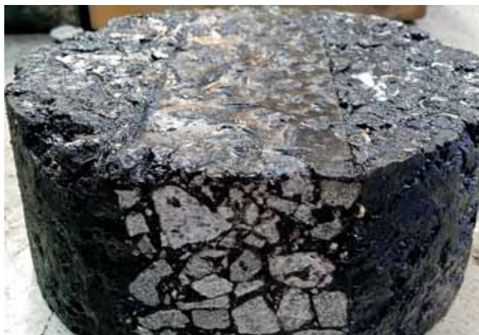
Рис. 3. Внешний вид образца после 20 тыс. проходов колеса при температуре 60°C
