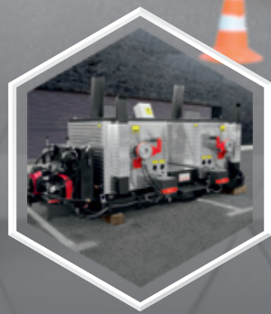
АВТОНОМНЫЕ КОТЛЫ ДЛЯ ПРИГОТОВЛЕНИЯ ТЕРМОПЛАСТИКА
