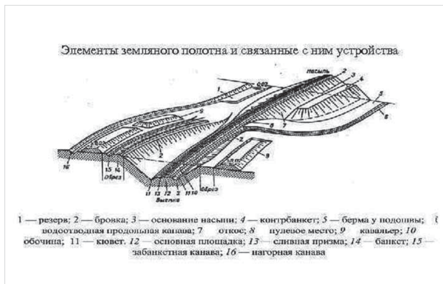
Рис. 5. Пример конструкции земляного полотна и сооружений водозащиты
