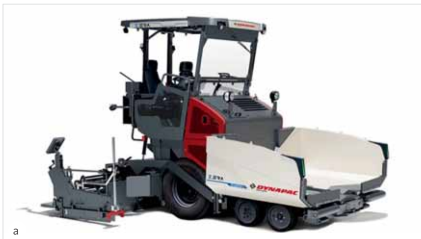
Рис. 1. Образцы перспективной дорожно-строительной техники и оборудования на низкоуглеродном топливе: а) Асфальтоукладчик с силовым электроприводом, характеризующийся пониженным уровнем антропогенных выбросов и шума, предназначенный для использования в городских агломерациях и подземных сооружениях (номинальная мощность электродвигателя в опытных образцах – 50–150 кВт, номинальное напряжение – 110–400 В); б) Горелка для асфальтобетонных заводов, использующая в качестве топлива водород
