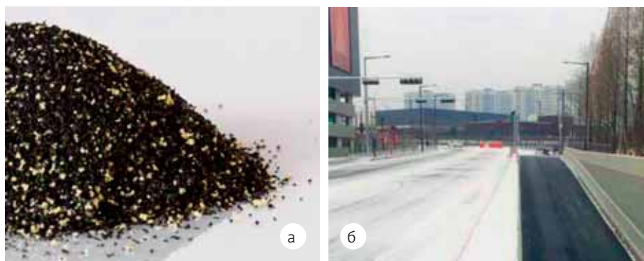
Рис. 4. Инновационные добавки, способствующие повышению потребительских характеристик участков дорог и улично-дорожной сети: а) Пример добавки на основе переработанной резиновой крошки для устройства асфальтобетона с пониженным уровнем шума; б) Пример устройства слоя покрытия традиционным способом и с использованием антиобледдительной добавки
