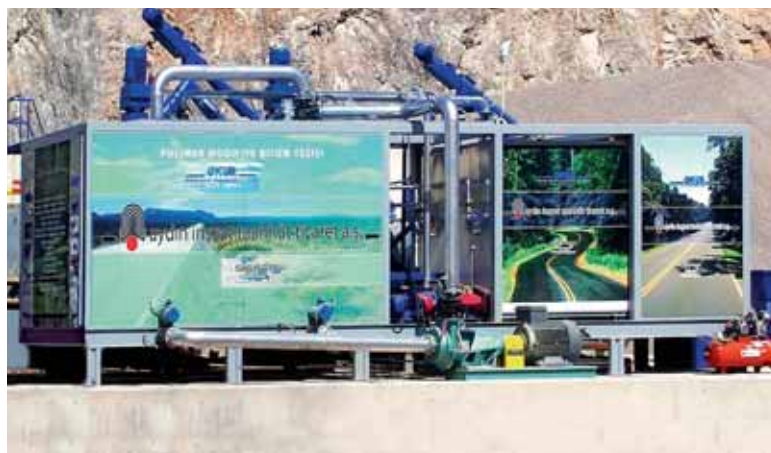
Рис. 5. Завод по производству битума, модифицированного полимерами, (ПМБ/ПБВ) OKUR PMB 20MP
