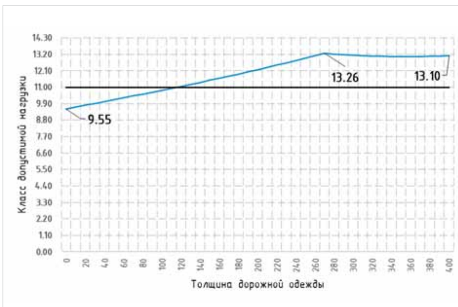
Рис. 7. Изотенза класса НК, для всех пролетов (типовой проект выпуск 167, инв. №227)
