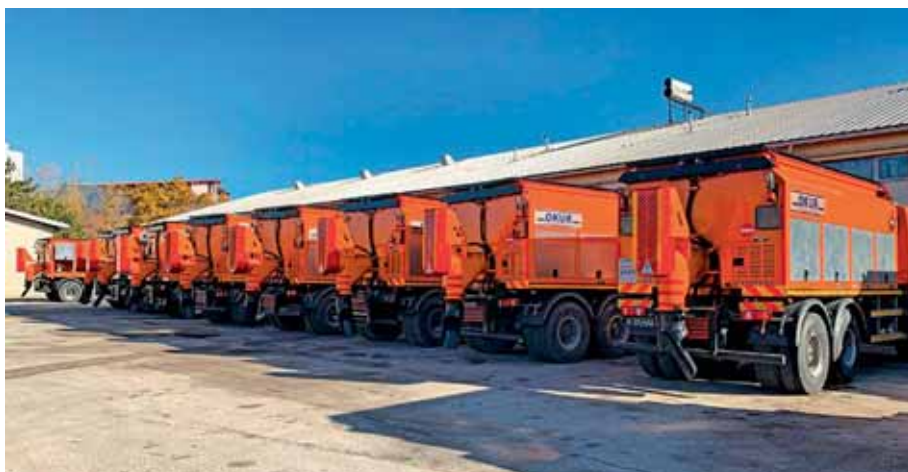
Рис. 3. Пример установки оборудования для поверхностной обработки на шасси автомобиля Mercedes
