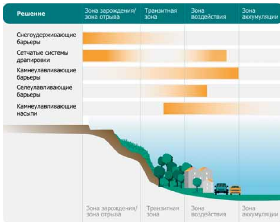
Рис. 1. Варианты применения систем инженерной защиты
