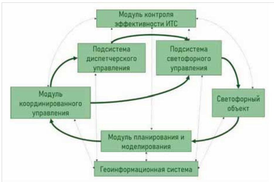
Рис. 4. Минимальная функционально значимая архитектура ИТС
