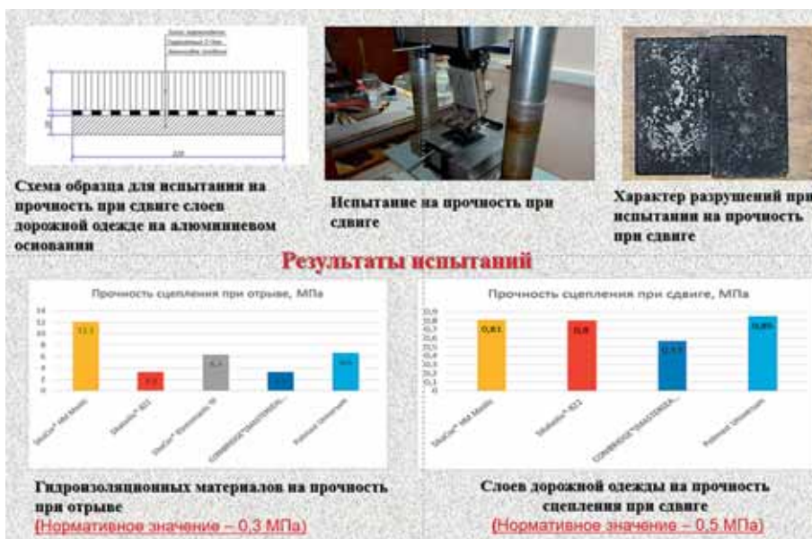
Рис. 5. Лабораторные испытания слоев одежды ездового полотна
